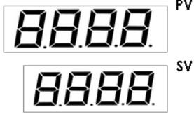
전원을 투입하면 측정온도표시창(PV)① 에 현재 CHAMBER 내부온도가 설정온도표시창(SV)② 은 설정온도가 표시됩니다.
